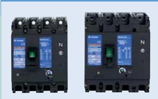
Les symboles de commande définis internationalement par l'IEC sont EN/ON (I) rouge, déclenché blanc et HORS/OFF (O) vert. La position "DECLENCHÉ" est atteinte si l'interrupteur est déclenché par une surcharge, un court-circuit, un déclenchement parallèle, de sous-tension, ou la touche de déclenchement. Après un déclenchement, le levier à bascule doit être amené au-delà de la position "HORS" (RESET), afin de réarmer l'interrupteur.
