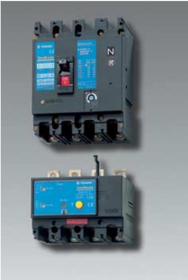
Les disjoncteurs de puissance 125A et 250A avec interrupteur différentiel de construction compacte. L'interrupteur est placé sous le disjoncteur de puissance proprement dit et assure un minimum de perte de place. Le montage et le câblage sont simples et efficaces.
