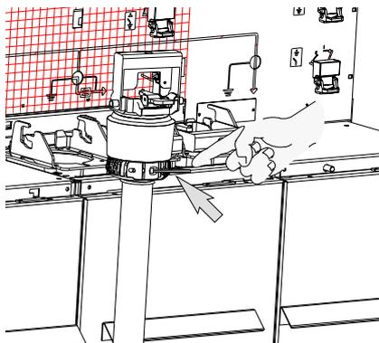
Desserrer le fusible à l'aide d'une clé à embout BTR no 5.
