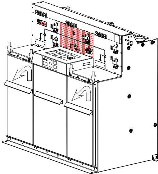
Ouvrir l'interrupteur fermer le sectionneur de terre
