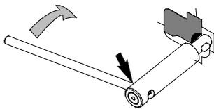
Lever le capot de protection de l'axe de manoeuvre.
