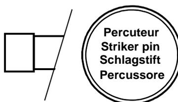
L'extrémité du fusible équipée du percuteur est repérée.
