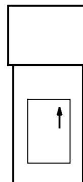
Les caractéristiques et le sens de montage du fusible sont imprimés sur le corps. (percuteur vers le haut)
