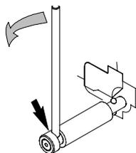
Ecarter la palette avec le bout du levier puis actionner la commande du sectionneur de mise à la terre vers la gauche.
