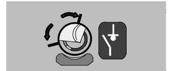
...l'interrupteur ou le disjoncteur est condamné.
