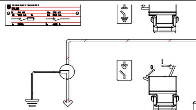
L'indicateur passe en position terre, et l'accès à l'axe de manoeuvre de l'interrupteur ou du disjoncteur est condamné.
