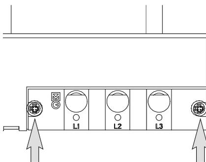
Démonter les 2 vis de fixation du boîtier indicateur de présence de tension.
