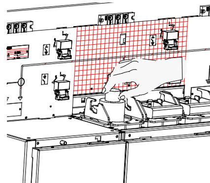
Introduire le fusible dans le puits. Mettre en place le centreur sur le fusible.
