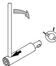
Lever le capot de protection de l'axe de manoeuvre. Actionner la commande de l'interrupteur vers la droite.
