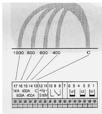
Pour changer de seuil effectuer le câblage approprié suivant le schéma ci-contre le bornier est situé à l'arrière de l'appareil.
