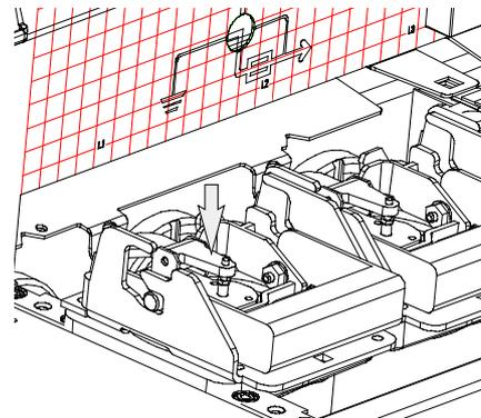
Bouchon avec déclencheur fusible, servant à provoquer l'ouverture triphasé de l'interrupteur. Appuyer sur le basculeur pour le mettre en position.
