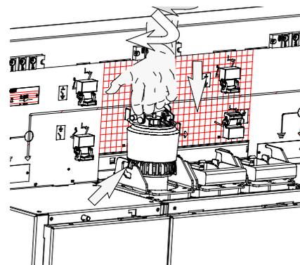
Engager l'ensemble bouchon et fusible dans le puits. Engager les ergots du bouchon dans le socle, le faire pivoter vers la droite.
