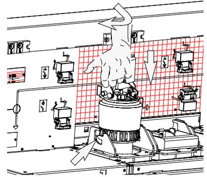
Engager l'ensemble bouchon et fusible dans le puits.
