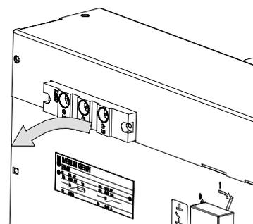
Extraire le boîtier indicateur présence de tension et débrancher le connecteur à l'arrière de celui-ci.
