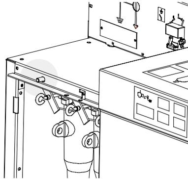
Sectionneur de mise à la terre ouvert le panneau d'accès ne peut être remis en place.
