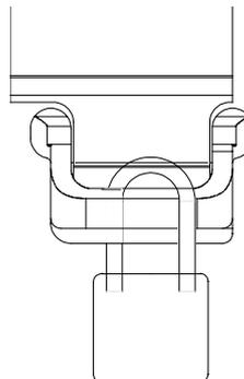
Interrupteur et sectionneur de mise à la terre avec un indice de protection IP3X, installer un cadenas  $6 \text{ mm} < \text{Ø d'anse} < 8 \text{ mm}$ .
