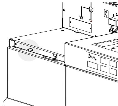
Unité fonctionnelle en service, interrupteur fermé. Le panneau d'accès est verrouillé
