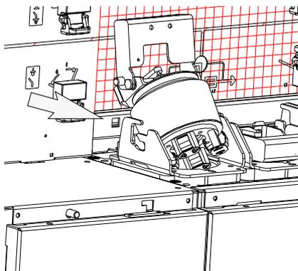
Si les bouchons des fusibles sont sales, nettoyer la surface conique avec de l'huile silicone.
