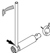
Actionner la commande de l'interrupteur vers la gauche.
