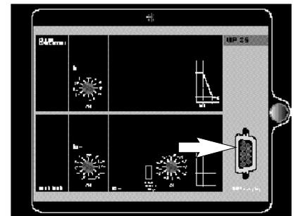
Connecter la **VAP6** sur la prise **“VAP6 test plug”**.
