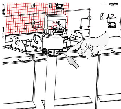
Fixer le fusible sur le bouchon à l'aide d'une clé dynamométrique à embout BTR n° 5, et engager le fusible dans le puits.
