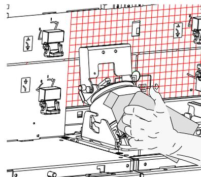
Talquer la surface propre avec du talc naturel pour éviter l'adhérence entre le bouchon et le puits fusible.
