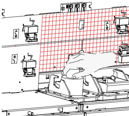
Introduire le fusible dans le puits. Mettre en place le centreur sur le fusible. Engager les ergots du bouchon dans le socle, le faire pivoter vers la droite.
