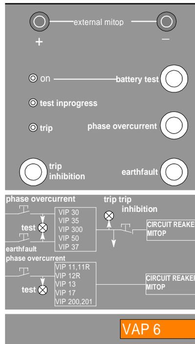
Le **VAP6** boîtier portable qui se connecte sur le **VIP 30, 35** ou **300** pour en effectuer un test simplifié.
