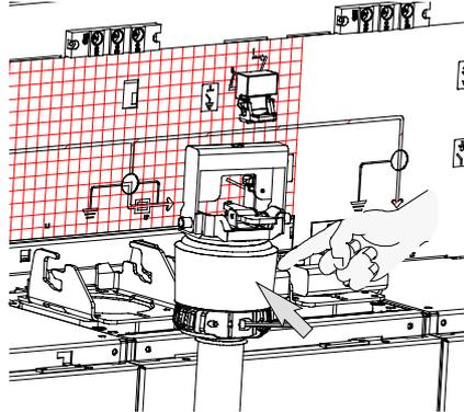
Fixer le fusible sur le bouchon à l'aide d'une clé dynamométrique à embout BTR no 5, et engager le fusible dans le puits.
