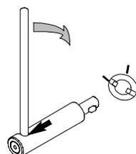
Lever le capot de protection de l'axe de manoeuvre.
