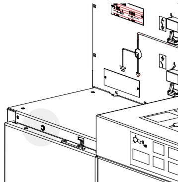
Fermer le sectionneur de mise à la terre. Le panneau d'accès est déverrouillé.
