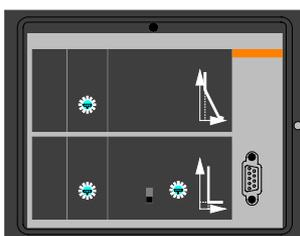
**VAP 6:** Appuyer sur le bouton **“trip inhibition”** si le test doit être fait sans déclenchement du disjoncteur.
