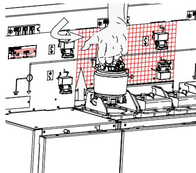
Monter le bouchon jusqu'à la butée, le faire pivoter vers la gauche pour l'extraire.
