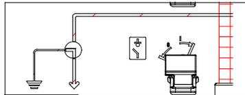
Sectionneur de mise à la terre fermé...
