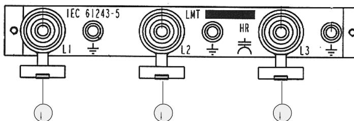
**VDS** : Voltage Détection Système, boîtier avec des prises permettant d'embrocher des indicateurs individuels. **A** : capots de protection.
