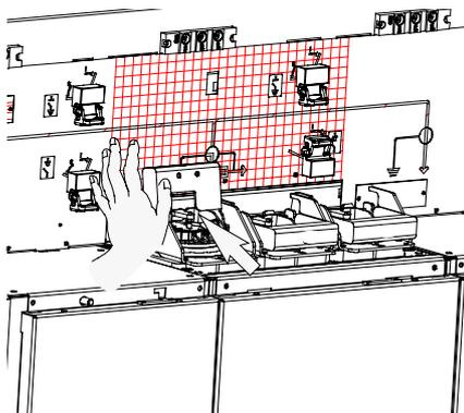
Déverrouiller le bouchon et pousser la poignée d'extraction à la main pour débloquer le bouchon, (taper avec la paume de la main pour décoller le joint du bouchon si nécessaire.)
