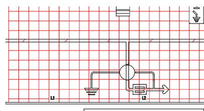
L'indicateur passe en position fermé, et l'accès à l'axe de manoeuvre du sectionneur de mise à la terre est condamné.
