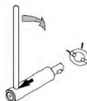
Lever le capot de protection de l'axe de manoeuvre. Actionner la commande interrupteur vers la droite.
