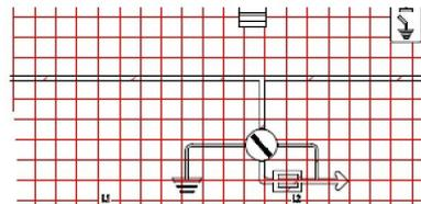
L'indicateur passe en position ouvert, et l'accès à l'axe de manoeuvre de l'interrupteur ou du disjoncteur est libéré.
