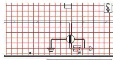
L'indicateur passe en position fermé, et l'accès à l'axe de manoeuvre du sectionneur de mise à la terre est condamné.
