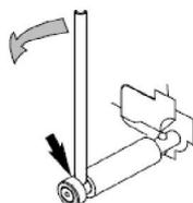
Ecarter la palette avec le bout du levier puis actionner la commande du sectionneur de mise à la terre vers la gauche.
