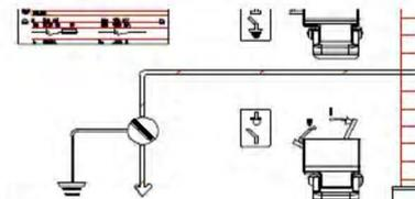
L'indicateur passe en position ouvert, et l'accès à l'axe de manoeuvre de l'interrupteur ou du disjoncteur est libéré.
