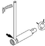
Actionner la commande de l'interrupteur vers la gauche.
