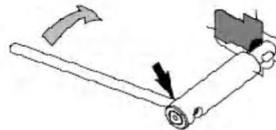
Lever le capot de protection de l'axe de manoeuvre. Ecarter la palette avec le bout du levier puis actionner la commande du sectionneur de mise à la terre vers la droite.
