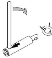
Lever le capot de protection de l'axe de manoeuvre. Actionner la commande de l'interrupteur vers la droite.
