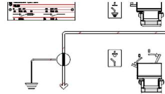
L'indicateur passe en position fermé, et l'accès à l'axe de manoeuvre du sectionneur de mise à la terre est condamné.
