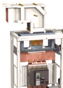
Raccordement direct de la canalisation Canalis KT sur le disjoncteur Masterpact 3200 A.
