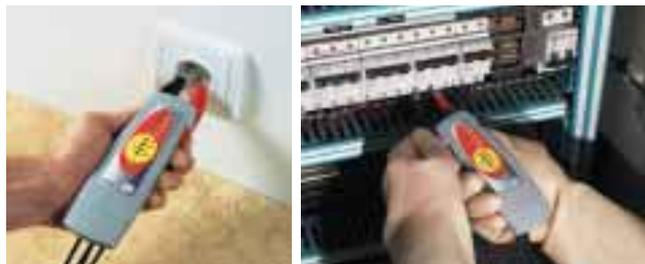
Adapté pour le contrôle des prises à éclipses (écartement entre pointes de 19 mm).
